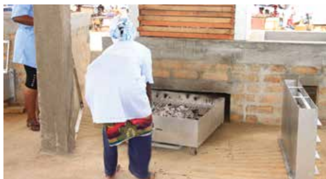
57 - Fourneau avec la braise bien attisée, poussé dans le four
