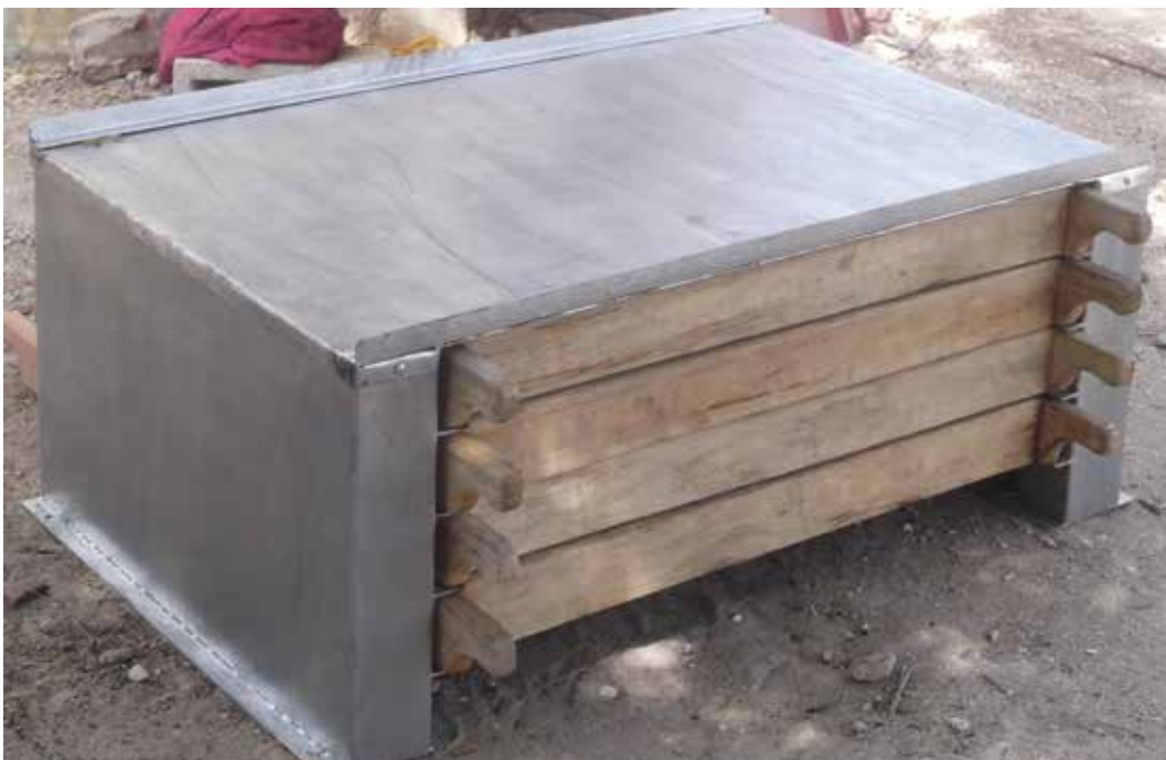
40 - Deux caissons métalliques avec 4 claies
