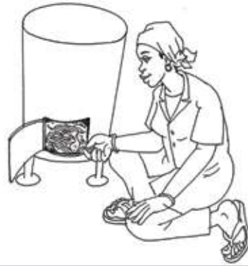
68 - Humidification et insertion du combustible dans le fût du générateur de fumée
