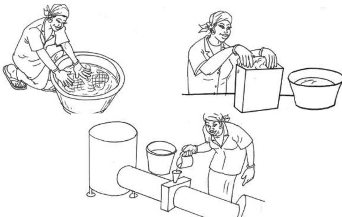
67 - Humidification et insertion de l'éponge végétale
