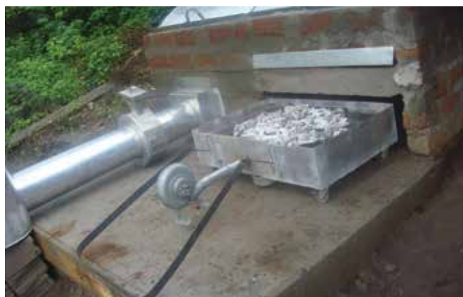
23 - Le fourneau muni d'une tirette démontable
