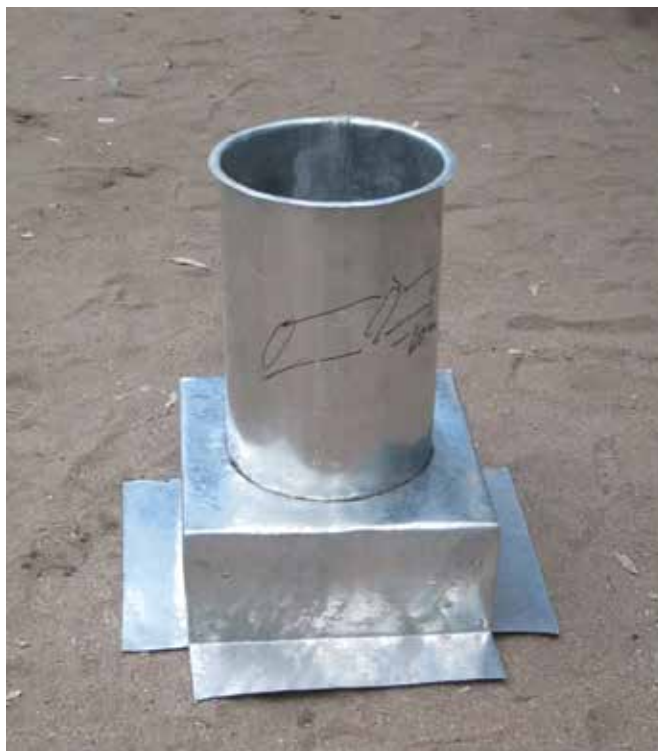
36 - Le tube qui épousera le portillon du compartiment de fumage
