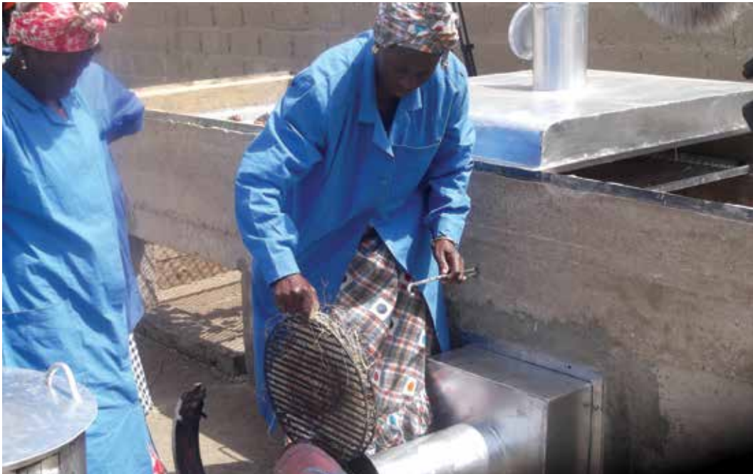
38 - Installation du filtre dans le boîtier métallique
