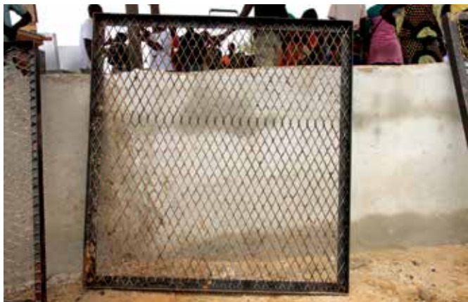
12 - Claie de fumage en acier galvanisé et cadre métallique
