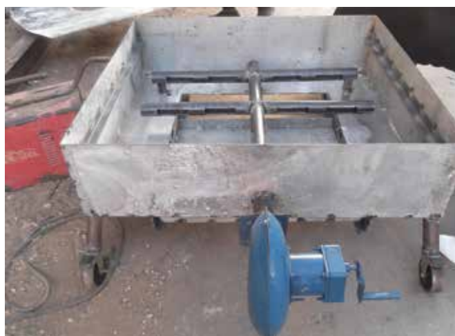
22 - Forge pour la ventilation et roues faciliter la manutention du fourneau
