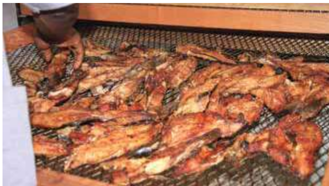
66 - Poisson fumé avec le FTT-Thiaroye et claie transférée du compartiment de cuisson au compartiment de fumage
