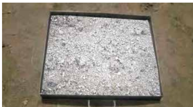
64 - Bac à cendre enlevé pour être vidé
