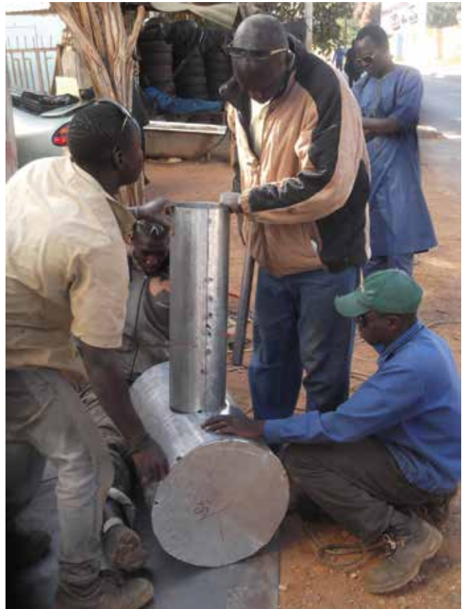
35 - Assemblage du baril et du tuyau
