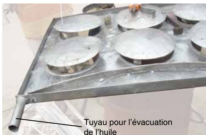
28 - Tube en fer arrondi soudé à la partie inférieure du collecteur
