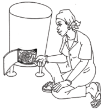
68 - Humidification et insertion du combustible dans le fût du générateur de fumée
