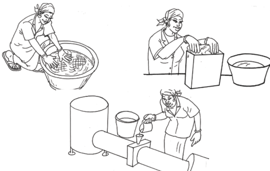
67 - Humidification et insertion de l'éponge végétale
